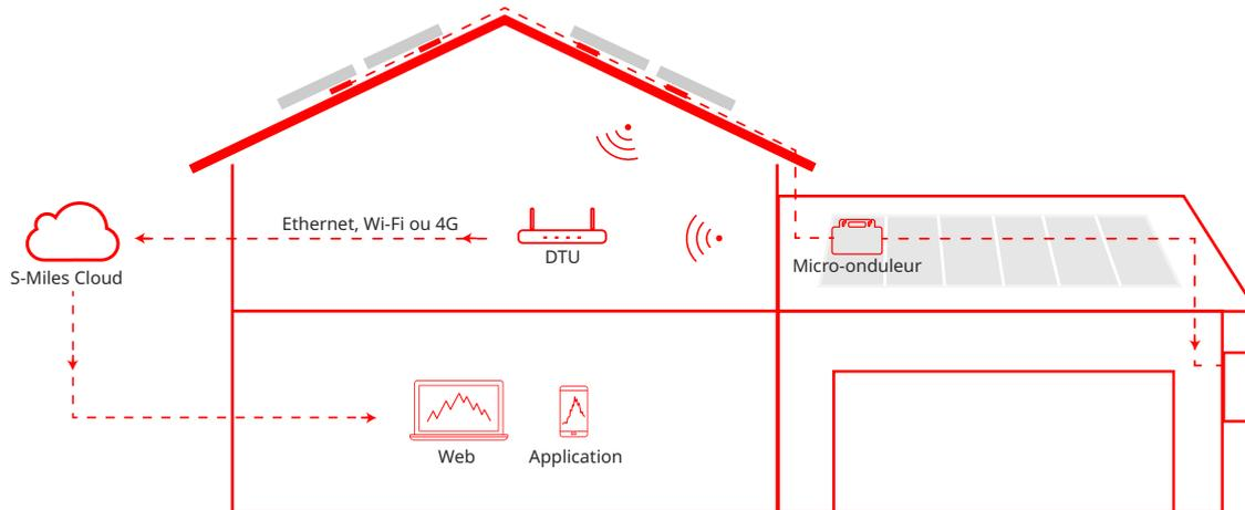
Le système complet de micro-onduleur photovoltaïque Hoymiles est composé d'un micro-onduleur photovoltaïque, d'une passerelle DTU Hoymiles et du système de surveillance Hoymiles S-Miles Cloud. Le micro-onduleur convertit le courant continu en courant alternatif et envoie les données de production d'énergie et de fonctionnement de chaque module au DTU.
